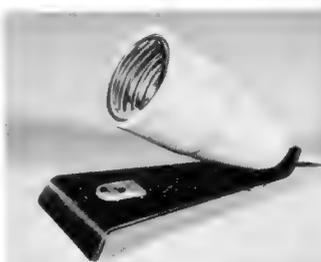
in Verbindung mit Tonbandgeräten. Die Frequenzkennlinie verläuft zwischen 100 und 10 000 Hz praktisch linear. Die abgegebene Spannung beträgt bei niederohmiger Ausführung 0,16 mV/µb (Mikrobar). Das Mikrofon ist tropfenfest ausgebildet und es besitzt ein Stativgewinde zum Aufschrauben auf Bodenständer. Die Maße sind 95 mm Länge und 50 mm größter Durchmesser (Deutsche Philips GmbH, Hamburg 1).
