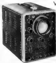
Vielseitig verwendbar in der HF-, NF- und Elektrotechnik. Vertikalverstärkung: 4 Hz - 4 MHz (Maximalverstärkung 1500fach) Breitbandverstärker: Frequenzbereich 2 Hz - 2 MHz. Mit Bildröhre B7 S1 und 5 x ECC B1, 1 x EZ 80, 2 x StR 90/40
