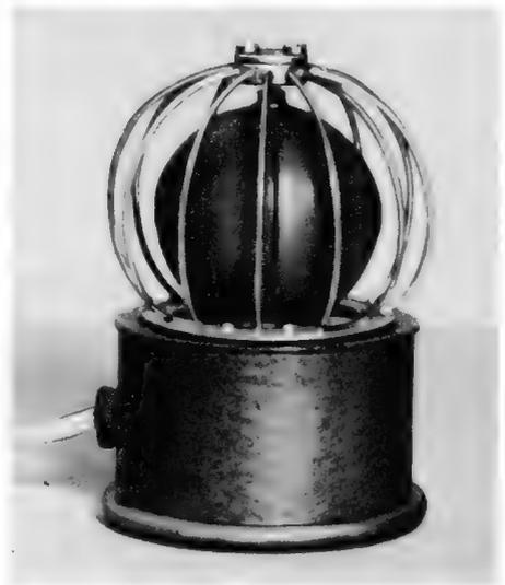
Bild 3. Betriebsmäßige Ausführung mit besonders angefertigter Papiermembran und Schutzgitter
