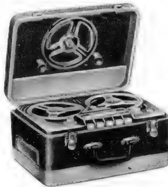
Tonband-Koffergerät mit 5 Drucktasten (Aufn., schneller Vorlauf, Halt, schneller Rücklauf, Wiedergabe) Bandgeschw. 19 cm/sec. Doppelspur. Kombin. Aufn.- und Wiedergabekopf, HF-Löschkopf und Vormagnet. Eingeb. Endstufe mit Kontroll-Lautsprecher, Aussteuerung d. Mag. Auge. Autom. Löschsperre. Anschluß für Mikrofon und Tonabnehmer für 350 m LA und 500 m LA-Band. Laufzeit für 350 m 2 x 30 Min.
